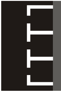
V 10a Státie (pozdĺž okraja vozovky)
